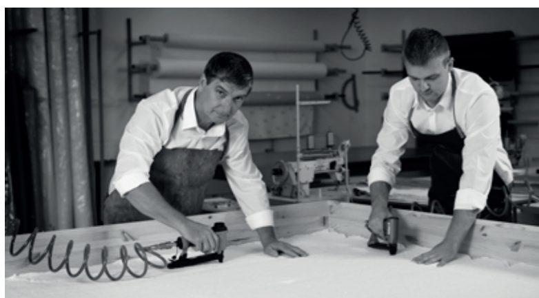
1. Upevnění izolantu v boxu
